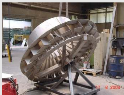
BSK®-Oberflächenbelüfter während der Herstellung im Biogest-Betrieb.
