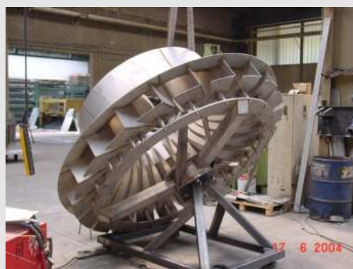
BSK®-Oberflächenbelüfter während der Herstellung im Biogest-Betrieb.
