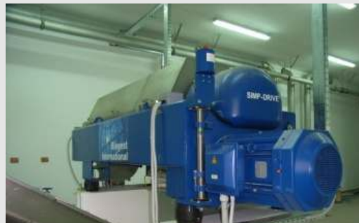
Hochleistungs-Schlammentwässerungszentrifuge mit einer Leistung von 25 m 3 Schlamm pro Stunde. Das Entwässerungsergebnis beträgt > 25 % TS.
