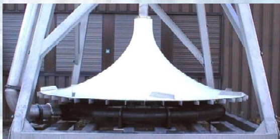
Abbildung Nr. 7: HYPERCLASSIC ® -Begasungssystem als so genannte "Käfervariante". Hierbei handelt es sich um einen in ein gefülltes Becken einsetzbaren Belüftungsturm, der alle notwendigen Bestandteile beinhaltet: HYPERCLASSIC ® -Rührwerk, Begasungsring, Stützkonstruktion und Druckluftzufuhrleitung (evtl. kann das Gebläse auch auf dem Turm montiert werden). Diese Form der Komplettinstallation ist insbesondere bei bestehenden Anlagen von Nutzen, die eine zusätzliche Belüftungs- und Rührereinrichtung benötigen, ohne dass das betreffende Becken entleert werden darf.
