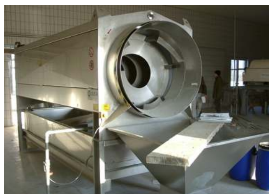
Blick auf die Siebtrommel (nach dem Einbau)
