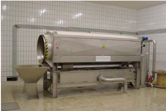
Gesamtansicht Siebtrommel einschließlich Reaktor und Abwurftrichter
