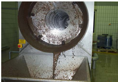
Einblick in die rotierende Siebtrommel (Auslaufseite)
