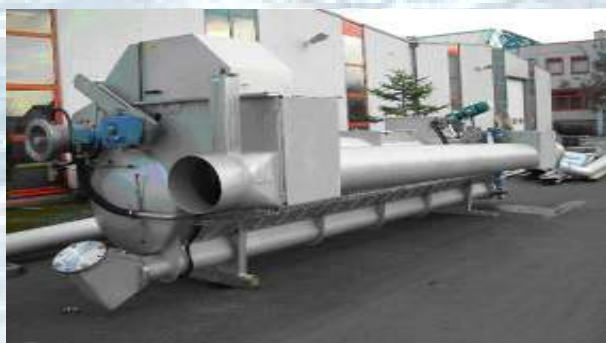
Kompakte Vorklärstation mit Walzensandfang kurz vor der Auslieferung.
