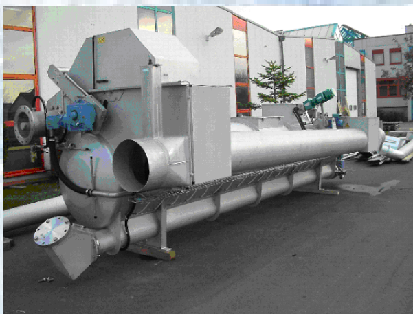
Kompakte Vorklärstation mit Walzensandfang kurz vor der Auslieferung.
