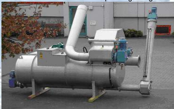
Beispiel für eine Kompaktstation mit Walzensandfang in auslieferungsbereitem Zustand (Kleinanlage für 60 l/s).
