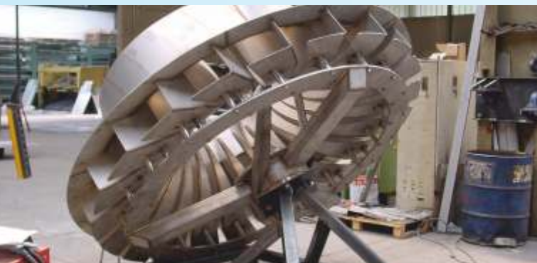
BSK®涡轮Ø 2,500 mm (生产阶段)
