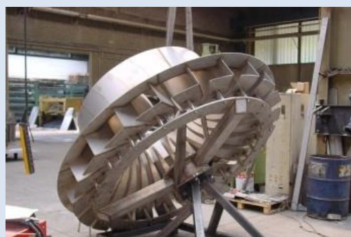
BSK®-Oberflächenbelüfter während der Herstellung im Biogest-Betrieb.
